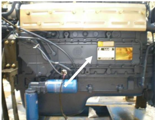
Место установки заводской таблички на двигателе WP10
