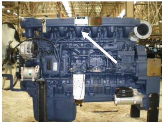
Место установки заводской таблички на двигателе WP12
